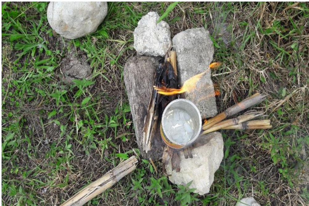
Fotografía N°10: Parafina para muestras extraer muestras inalteradas
