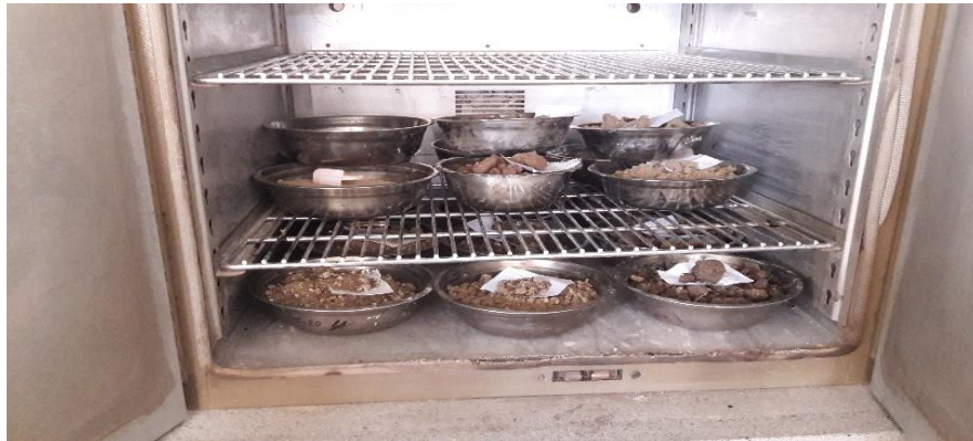
Fotografía N°15: Muestras colocadas al horno
