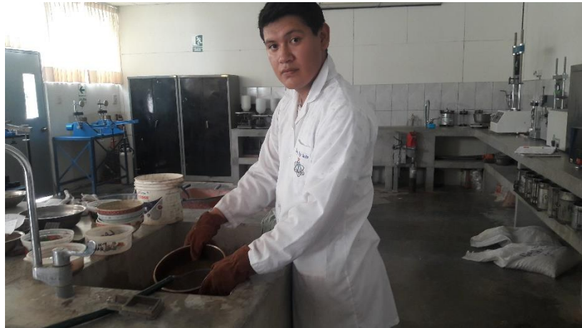
Fotografía N°18: Lavado de las muestras con la malla N°200
