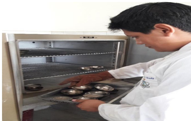
Fotografía N°23: Colocación de muestras al horno
