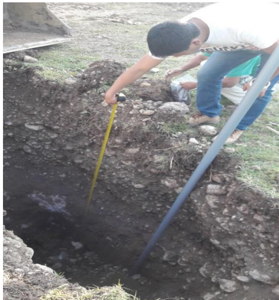
Fotografía N°08: Medición de estratos
