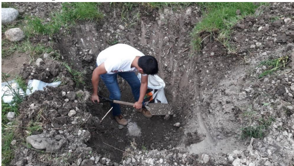
Fotografía N°06: Extracción de muestras de Calicata N°04
