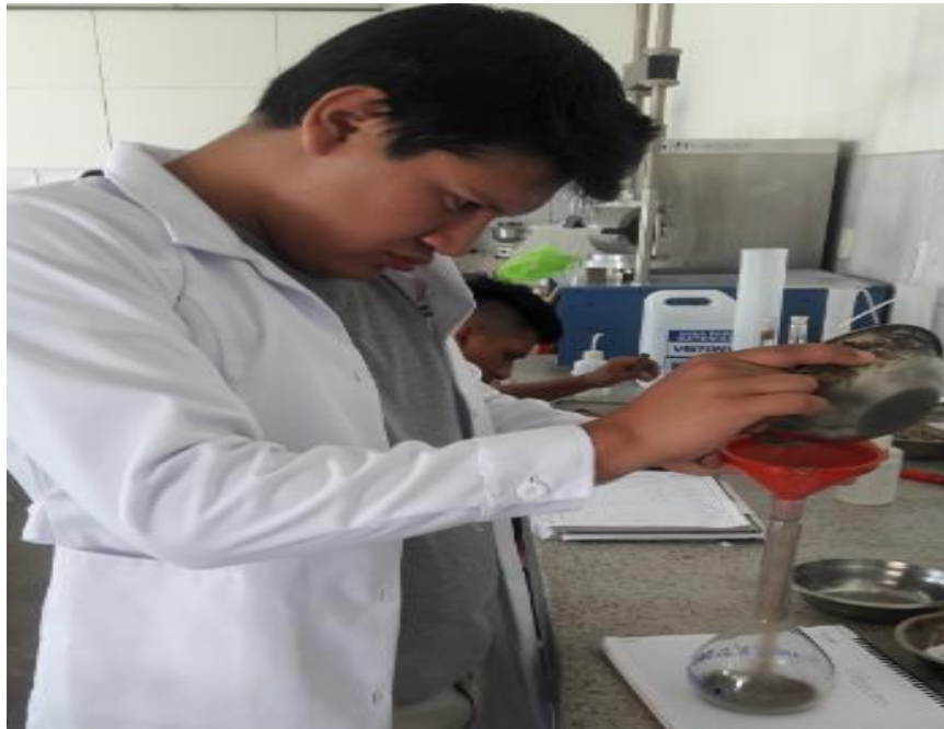
Fotografía N°24: Ensayo de Peso volumétrico
