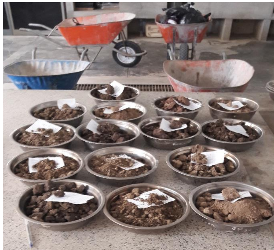
Fotografía N°14: Muestras pesadas y listas para colocar al horno
