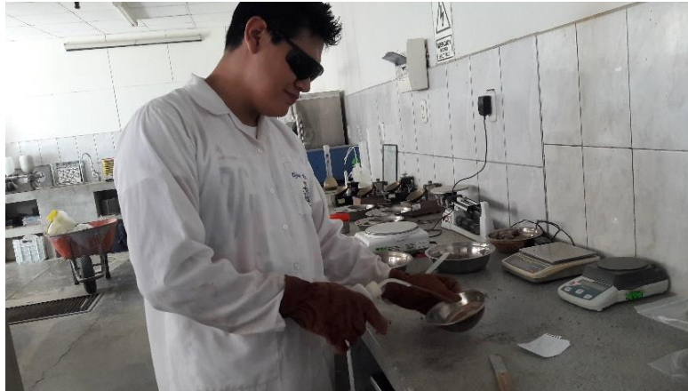
Fotografía N°21: Preparación de muestras para Límite líquido y plástico
